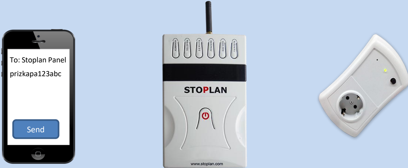
Şekil 12.2: Cep Telefonu, Kontrol Ünitesi ve Kablosuz Priz uzaktan cihazları kapama ilişkisi
